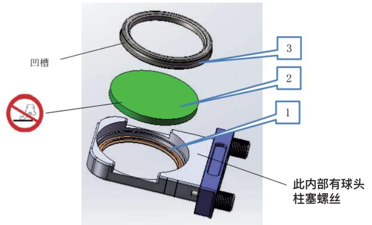
1、弹性密封圈 2、保护镜片 3、保护镜压板
