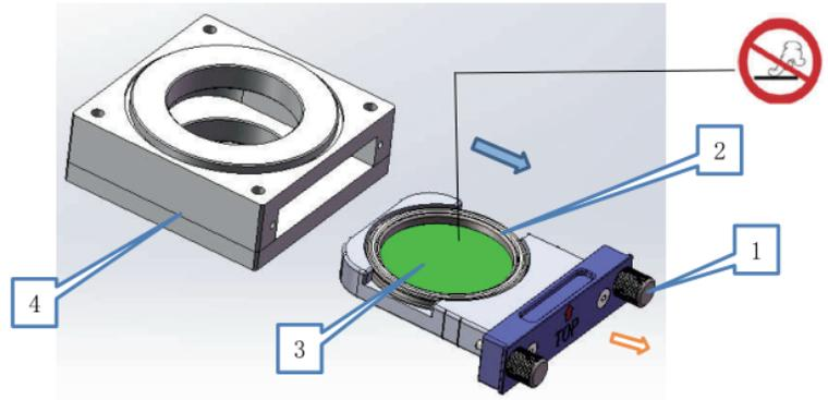
1、锁紧螺柱 2、镜片压圈 3、保护镜片 4、保护镜座
