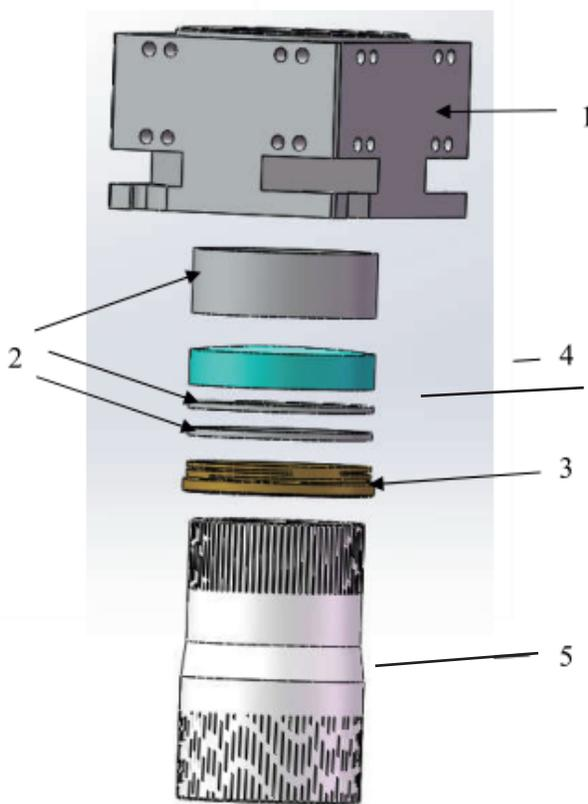
1、准直镜腔 2、垫圈 3、弹簧压圈
