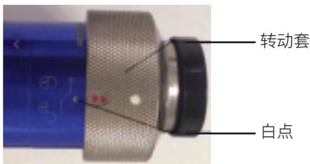
**第三步：** 取下QBH的防尘盖，将清洁好的光纤头与QBH同轴，并保证QBH上的白点与光纤头的定位槽（光纤头上的长槽）在同一直线上，再将光纤头轻轻插入QBH，直至光纤头与QBH两接触面贴合。
