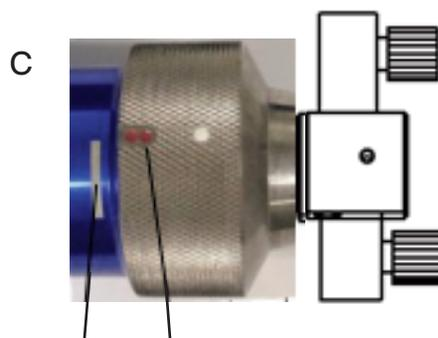
提起转动套继续转动之后，红点应位于白线范围内或接近白线末端。转动套底部应与QBH顶部平齐。
