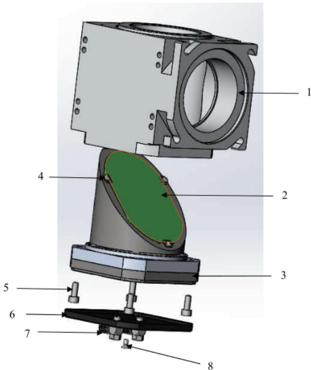
1 分光镜腔；2 分光镜；3 分光镜座；4 十字槽盘头螺丝与压扣；5 内六角圆柱头螺丝；6 装饰盖；7 水管弯接头；8 十字平头螺钉；9 机米螺丝
