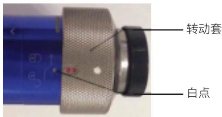
**第二步：**把光纤棒的防尘盖取下，用无尘清洁棒和无水乙醇清洁光纤棒头部。安装前，必须检查光纤棒水晶头之保护帽是否锁紧，避免保护帽在机器工作时因为松动而影响焊接效果、烧毁光纤头或切割头。
