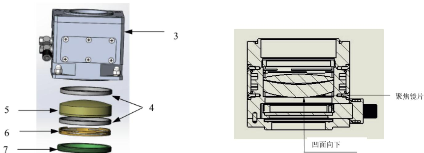
3, 聚焦镜组件； 4, 垫圈； 5, 聚焦镜片；
