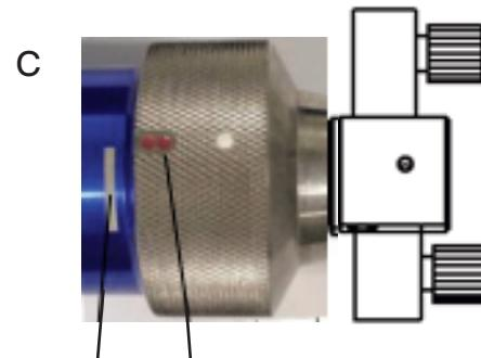
提起转动套继续转动之后，红点应位于白线范围内或接近白线末端。转动套底部应与QBH顶部平齐。
