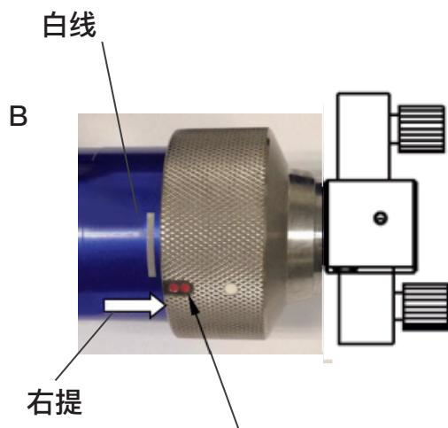
转动套旋转15度后，红点位置靠近外套白线，此时应向右提起转动套。
