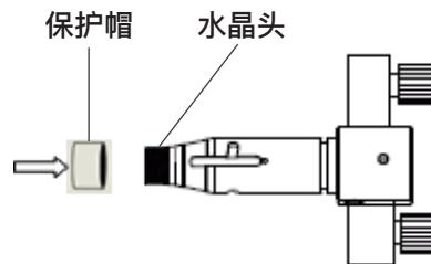
**第三步：**取下QBH的防尘盖，将清洁好的光纤头与QBH同轴，并保证QBH上的白点与光纤头的定位槽（光纤头上的长槽）在同一直线上，再将光纤头轻轻插入QBH，直至光纤头与QBH两接触面贴合。
