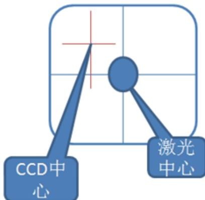
在工作的过程中，CCD图像中心（十字架交叉点）必须与激光中心重合。
