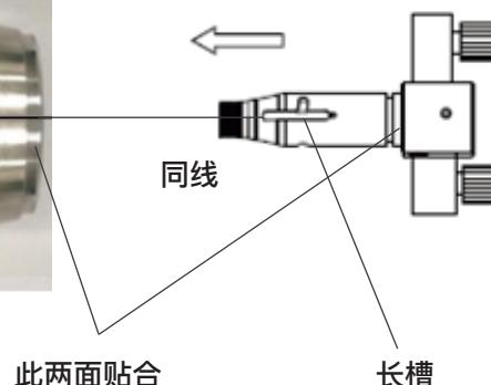
**第四步：**光纤头插入QBH后，用手轻压转动套，并沿转动外套上箭头方向旋动转动套约15度。到位后，用手提起转动套，直至转动套底面基本与QBH顶部平齐，再以相同方向旋转转动套至极限即可。转动力度应适中。
