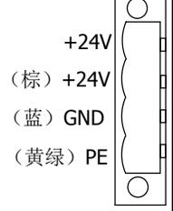
!!! 切勿错接入-24V电源到GND上, 否则将达到48V烧毁电路
