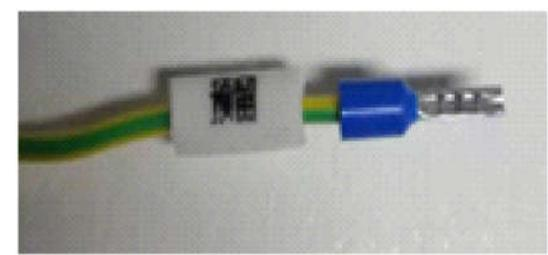
!!! 注意: 开关&安全锁引出线10米的一根黄绿色 (预留) 线必须接入GND (可接入13或14号端子) (避免干扰引入主板, 起屏蔽干扰作用)
