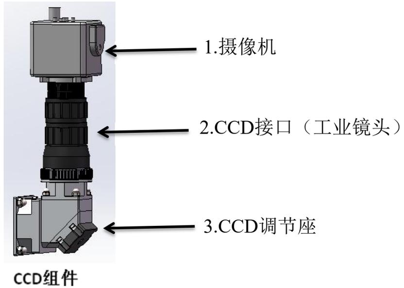
CCD组件相机安装步骤：
