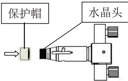
**第三步：**取下QBH的防尘盖，将清洁好的光纤头与QBH同轴，并保证QBH上的白点与光纤头的定位槽（光纤头上的长槽）在同一直线上，再将光纤头轻轻插入QBH，直至光纤头与QBH两接触面贴合。
