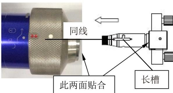
**第四步：**光纤头插入QBH后，用手轻压转动套，并沿转动外套上箭头方向旋转转动套约15度。到位后，用手提起转动套，直至转动套底面基本与QBH顶部平齐，再以相同方向旋转转动套至极限即可。转动力度应适中。
