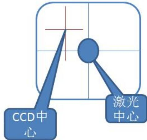
**特别注意事项：** 启动调整螺丝前，必须先松开对角螺丝，为CCD构件移动腾出空间。切忌盲目紧拧调整螺丝而损坏CCD构件。
