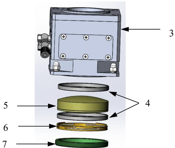
3聚焦镜组件；4, 垫圈；5, 聚焦镜片；6, 锁紧弹圈；7, 锁紧环。
