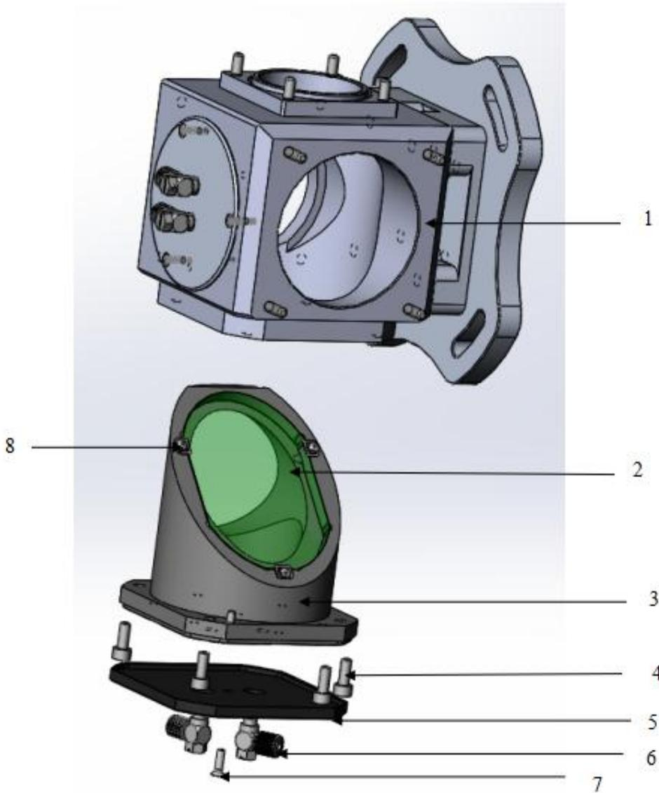
1,分光镜腔；2,分光镜；3,分光镜座；4,内六角圆柱头螺丝；5,装饰盖
