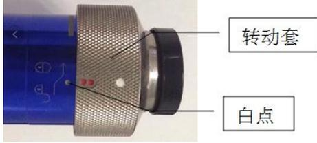
**第二步：**把光纤棒的防尘盖取下，用无尘清洁棒和无水乙醇清洁光纤棒头部。安装前，必须检查光纤棒水晶头之保护帽是否锁紧，避免保护帽在机器工作时因为松动而影响焊接效果、烧毁光纤头或切割头。
