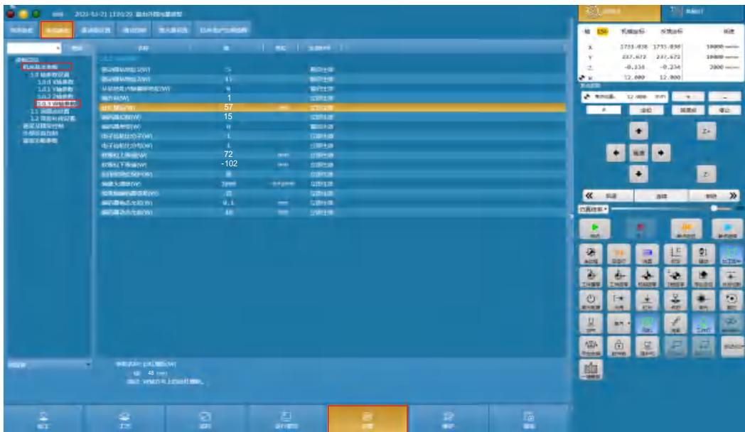
操作流程：设置 > 系统参数 > 1.0 轴参数设置 > 1.03 W轴参数 > 丝杆螺距
