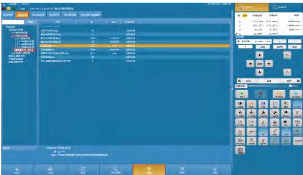
操作流程：设置 > 系统参数 > 1.1 回原点设置 > 1.14 W轴原点设置
