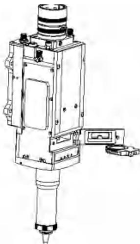
拆开方式：拧松锁紧防脱螺丝，然后将抽屉取出
