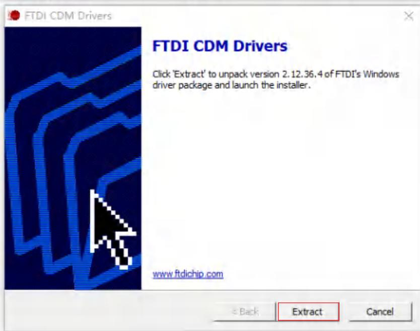
操作流程：打开串口线FT231XS芯片驱动文件 > Windows > Windows 8 10 11 > > CDM212364\_Setup > Extract
