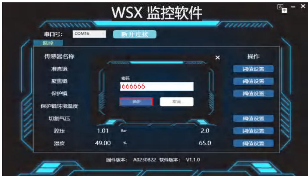
操作流程：阈值设置 > 输入密码（666666）> 确定
