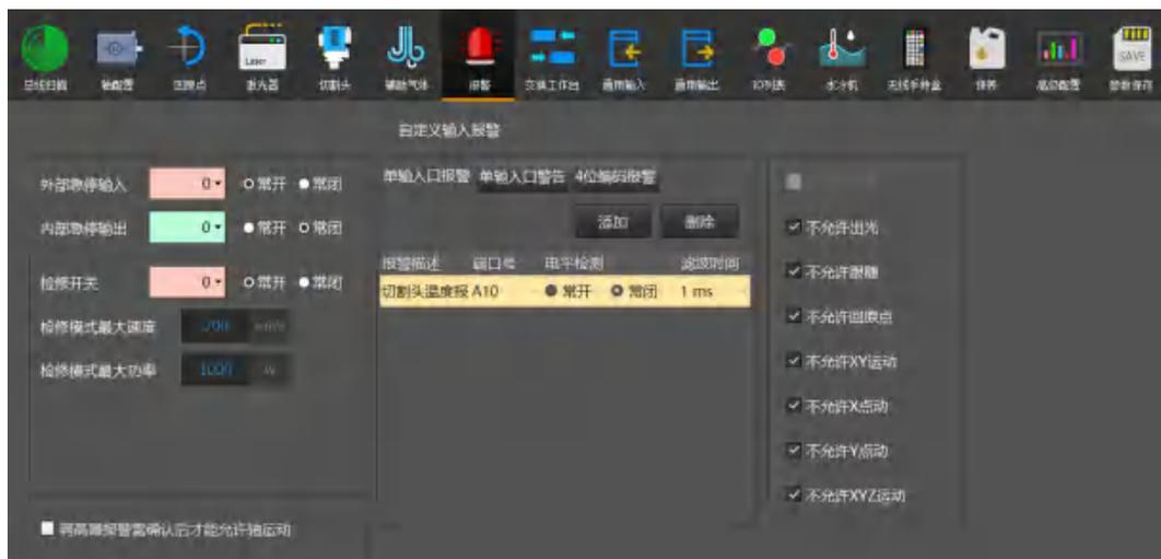
操作流程：点击报警>单输入口报警>添加>输入报警描述>选择对应端口>选择高低电平>保存
