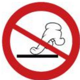
切勿用裸手接触激光头内的镜片高清洁度区域，镜片上灰尘及附着脏物可能造成激光镜片的烧焦损坏。
