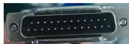
DB25, 接焊接头控制接口 (+15V接V1,-15V接V2)
