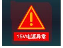
(故障) 驱动板电源不匹配或者现场存在氩弧焊干扰！
