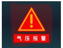
(故障) 气压输入报警，请检查气压设备！
