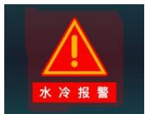
(故障) 水冷输入报警，请检查水冷设备！
