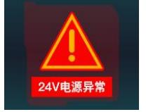
(故障) 控制板电源不匹配或者现场存在氩弧焊干扰！
