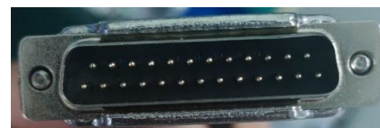
DB25，接焊接头控制接口
